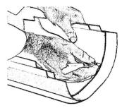
Zunächst wird der Kappenmantel an die notwendige Isolierlänge der Armatur angepasst. Diese Baulänge der Kappe hängt davon ab, ob und wie weit die Kappe die angrenzende Rohrisolierung überlappen soll. Mit Hilfe einer stabilen Schere (besser: Blechschere) kann der Kunststoff-Kappenmantel nach Bedarf gekürzt werden, wobei
