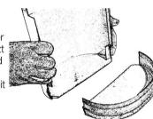
Ausschnitte für die Stellradspindel und andere Aussparungen können ebenfalls mit einer Blech-/Lochschere ausgeführt werden.
