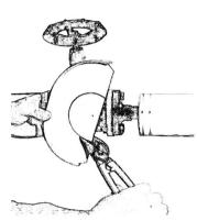
Es ist oft effektiver, die Kältedämmung mit Zellkautschuk Es ist οπ ellektiver, die Natedammans mit Zollkautschukteile aus einer auszuführen. Hierbei werden die Zellkautschukteile aus einer dämmdicken Platte mit einem Messer herausgeschnitten. Der Kappendeckel dient als Schablone! Zuerst werden die 4 Teile für die Deckelhälften zugeschnitten und innenseitig an die Deckel ge-
